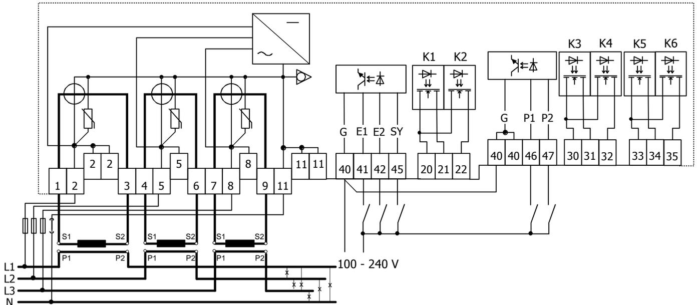
Zähler nach Schema im Zählerfrontdeckel anschliessen.
